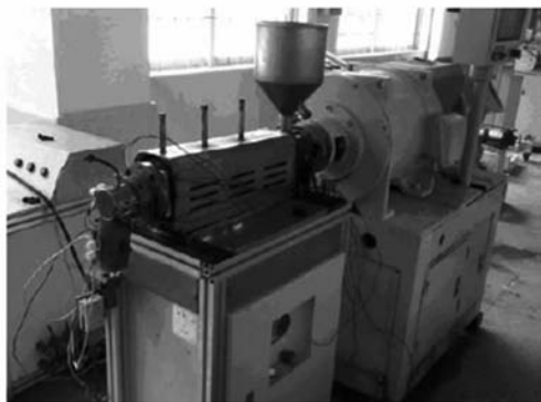
图1 聚合物电磁动态塑化挤出成型装置
